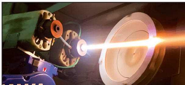
Сверхзвуковое воздушно-плазменное напыление износостойкого покрытия WC/10Co4Cr на рабочую поверхность детали гидравлического оборудования
