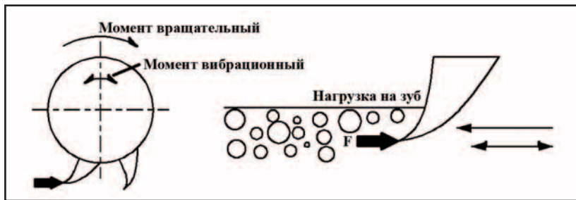
Рис. 2. Колебания, наложенные на вращение рабочего органа портового роторного заборщика
